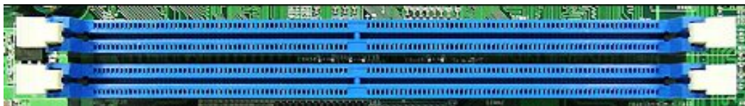
240 針的 DDR2 DIMM 插槽
